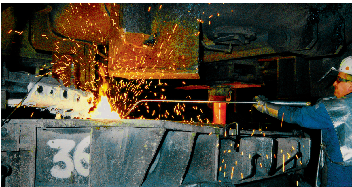
Badtemperaturmessung im Tundish
